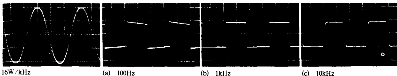
图7 Capehart TYPE-B 功放正弦波与方波特性
