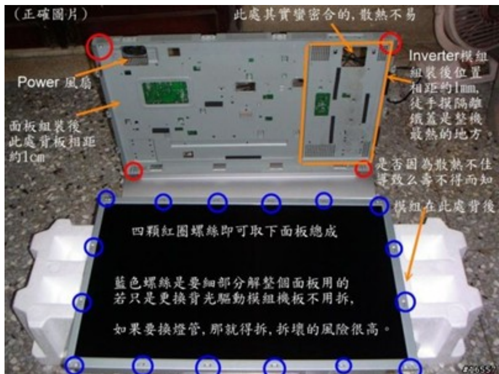
图五 “Inverter”即背光灯的供电模块
