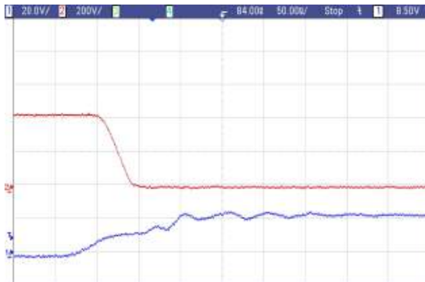
图4-4 - 晶体管开关细节 - 额定输入电压和输出参数 60 V 15 A 时的 D-S（红色）
