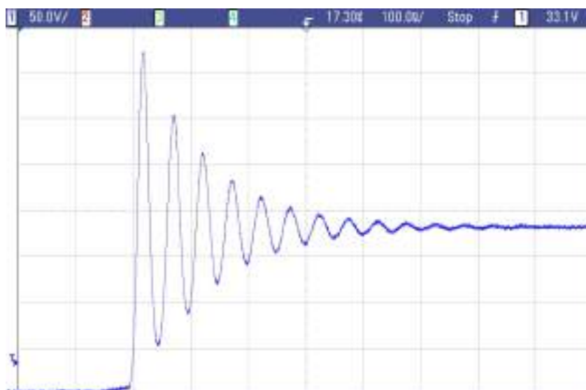
图4-8 - 在标称输入电压和输出参数为 60 V 20 A 时，次级整流二极管的电压波形详图
