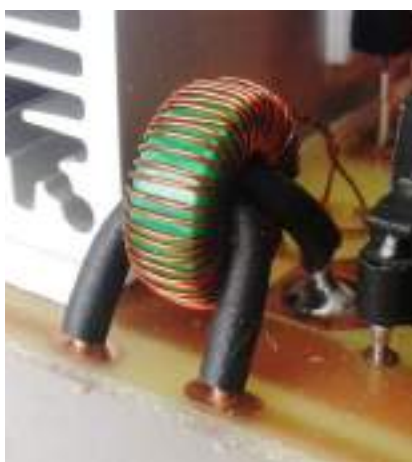
图4-1 - 带两个初级通孔的电流互感器
