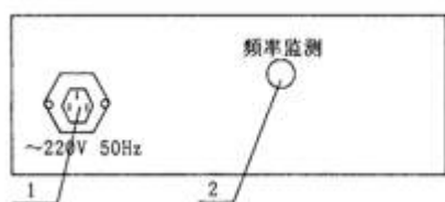
图 四 Q 表后面板示意图
